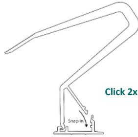
Figure 25 - 2 étapes de la mise en œuvre du crochet Proline.
